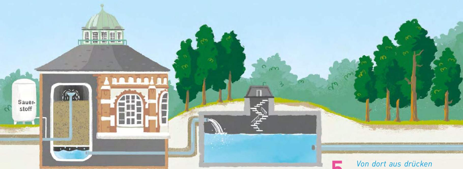
**3.** Im Wasserwerk wird das Wasser mit Sauerstoff vermischt, wodurch die winzigen Metalle rosten. Das Wasser mit den Rostflocken läuft dann durch einen Filter aus Kies. Dabei bleibt der Rost am Kies hängen. Jetzt ist das Wasser endlich Trinkwasser.
