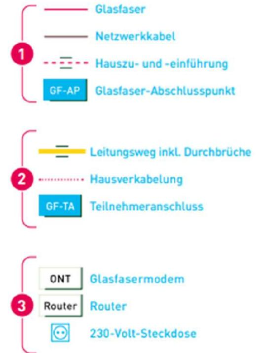
In der Regel erfolgt der Glasfaserausbau nach unserer Standardausbauweise, bei der der Glasfaser-Teilnehmeranschluss (GF-TA) direkt mit dem Router verbunden wird. Sollte die bauliche Situation oder die individuelle Nutzung es erfordern, besteht alternativ die Möglichkeit eigeninitiativ, ein LAN-Kabel (Netzwerkkabel) zwischen dem Glasfaseranschluss und dem Router zu verlegen.
